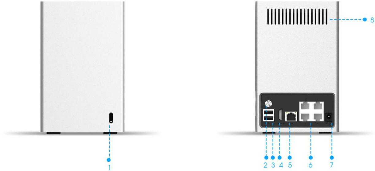
1. Indicador LED 2. Alimentación 3. USB 4. HDMI 5. LAN 6. Puerto PoE 1/2/3/4 7. Alimentación 8. Orificio de Ventilación
